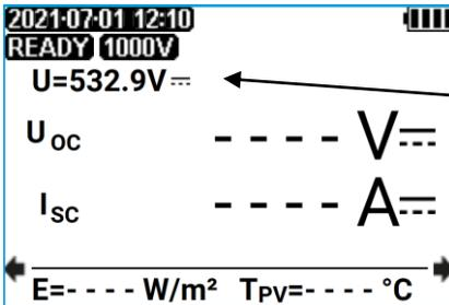
El medidor está listo para medir si detecta la tensión  $U_{oc} \geq 10 \text{ V}$ .
