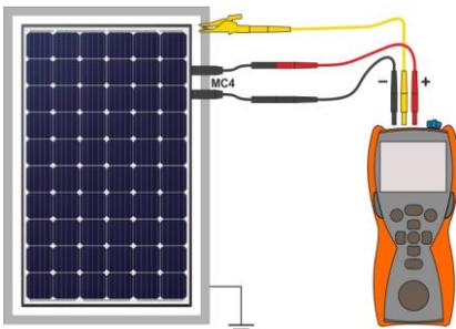
La instalación fotovoltaica tiene una estructura accesible y conectada a tierra (incluidos los marcos de módulos). Entonces una medición es suficiente.
