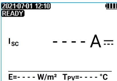
El medidor está listo para medir si detecta la tensión  $U_{dc} \geq 10 \text{ V}$ .
