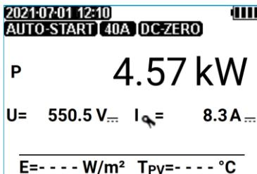
P - potencia generada (con signo negativo) o consumida (con signo positivo) por el objeto de ensayo
