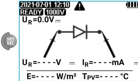
Pulsar **SET/SEL** para que aparezca la pantalla de medición de corriente y tensión negativa (inversa). Este ensayo verifica si el diodo de bloqueo resiste correctamente la tensión de 1000 V en la dirección inversa.
