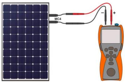
Conectar los cables de medición según la figura.
