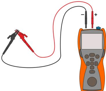
Conectar los cables de medición según la figura.
