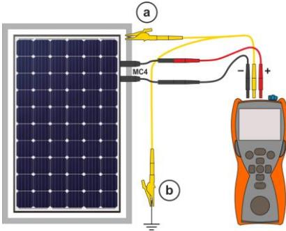
La instalación fotovoltaica no tiene una estructura puesta a tierra. Entonces son necesarias dos mediciones:
