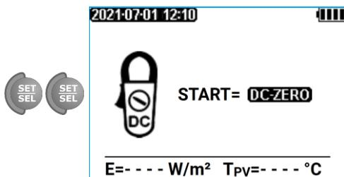
Pulsar **START** reinicia el dispositivo, obligando al medidor a indicar la corriente de cero. Solo entonces se puede conectar la pinza al objeto examinado.
