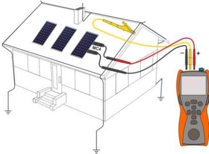
La instalación fotovoltaica no tiene piezas conductoras disponibles (por ejemplo, teja fotovoltaica). Entonces, la medición debe realizarse entre los conductores de instalación "+" y "-" y la puesta a tierra del edificio.
