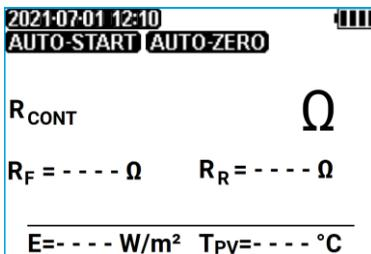
Después de terminar la puesta automática a cero, el medidor pasa automáticamente a la pantalla de espera para la medición.
