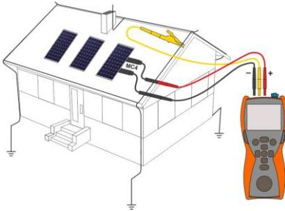
La instalación fotovoltaica no tiene piezas conductoras disponibles (por ejemplo, teja fotovoltaica). Entonces, la medición debe realizarse entre los conductores de instalación "+", "-" y la puesta a tierra del edificio.
