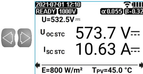
U<sub>OC STC</sub> – la tensión medida U<sub>OC</sub> convertida a condiciones STC
